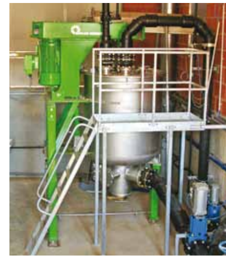
Der patentierte Kreis-Biogas-Dissolver zerkleinert die Inputmaterialien zu einem leicht zu verarbeitenden Futterbrei und ist in seiner Effizienz herkömmlichen Systemen weit überlegen.
